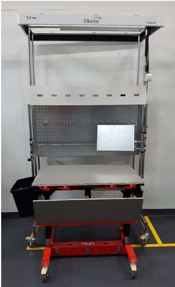
Kuva 11. Tuotannon uusi työpiste. Työpiste on ESD-suojattu, varustettu korkeuden säädöllä ja merkitty keltaisin nauhoin.
