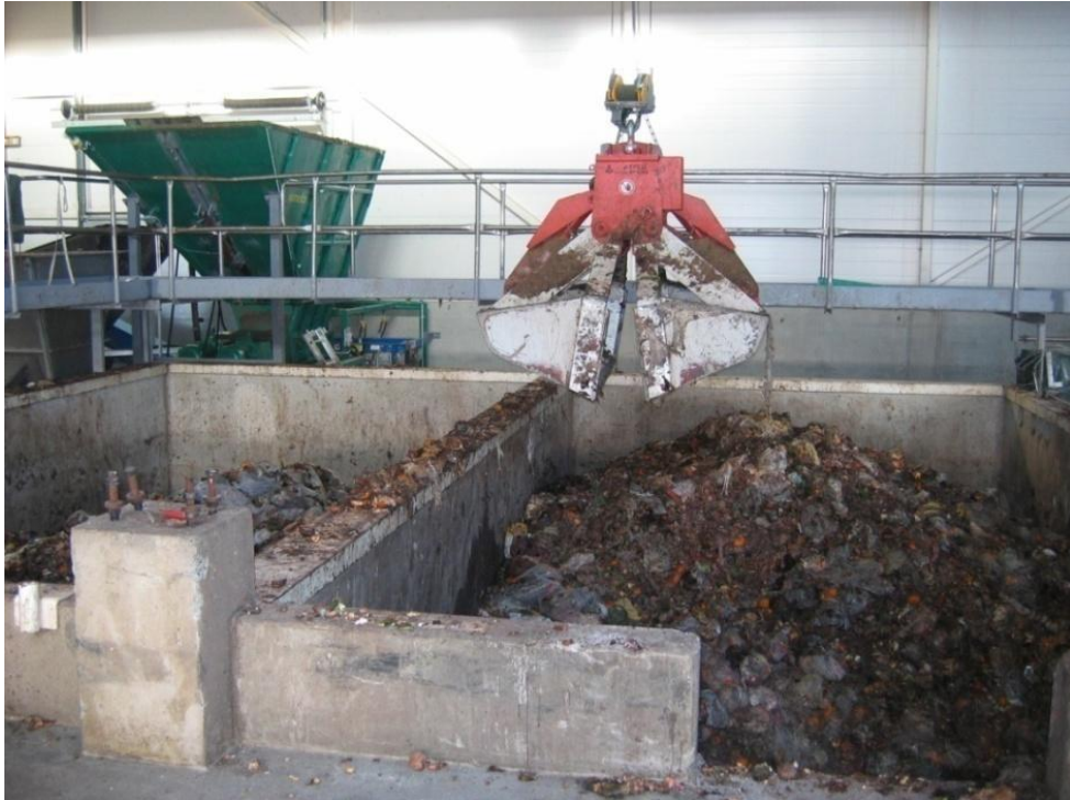
Kuva 12. Siltanosturilla biojätettä nostetaan taustalla näkyvään vihreään esimurskaimeen. Kuva: Keikko K, Heiskanen H)
