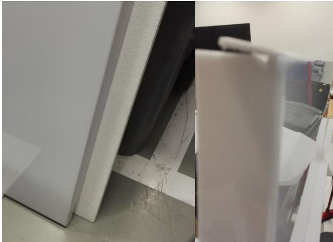
Kuva 54. Vasemmalla osa polykarbonaatista taivutetun pinnan laitaa ja oikealla yksi sen ongelmallisista nurkista.
