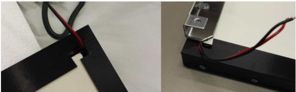
Kuva 62. LED-nauhan johtojen ulosvetoa varten valaisimen yläprofiileihin tehty aukko vasemmalla vain rungon ollessa kasassa ja oikealla saranan kiinnityspalan yhteydessä.
