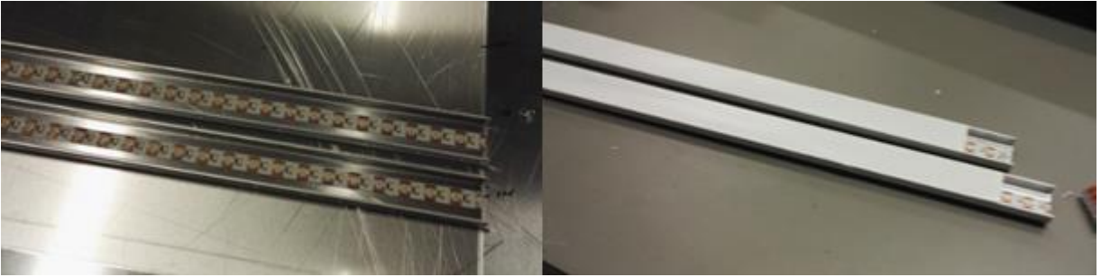
Kuva 57. Vasemmalla U-uran muotoisiin taustalistoihin asennetut LED-nauhat ennen valonhajautuskalvon asentamista ja oikealla sen jälkeen.
