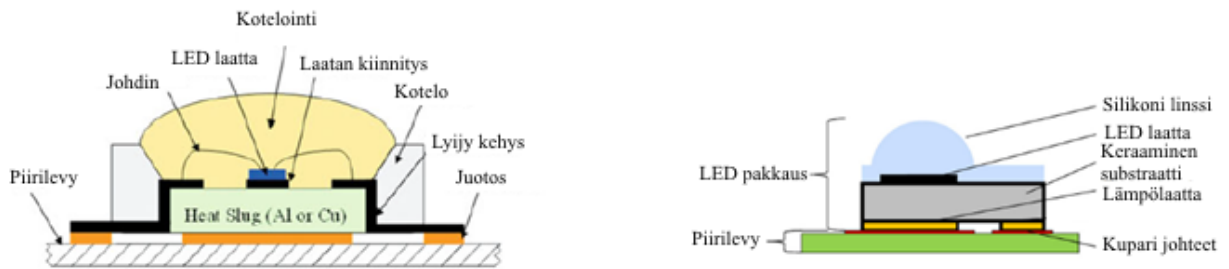
Kuva 5. Kaksi erilaista LED-pakkausesimerkkiä (Heat Slug = lämpönielu, or = tai) [mukailten 3 ja 6].
