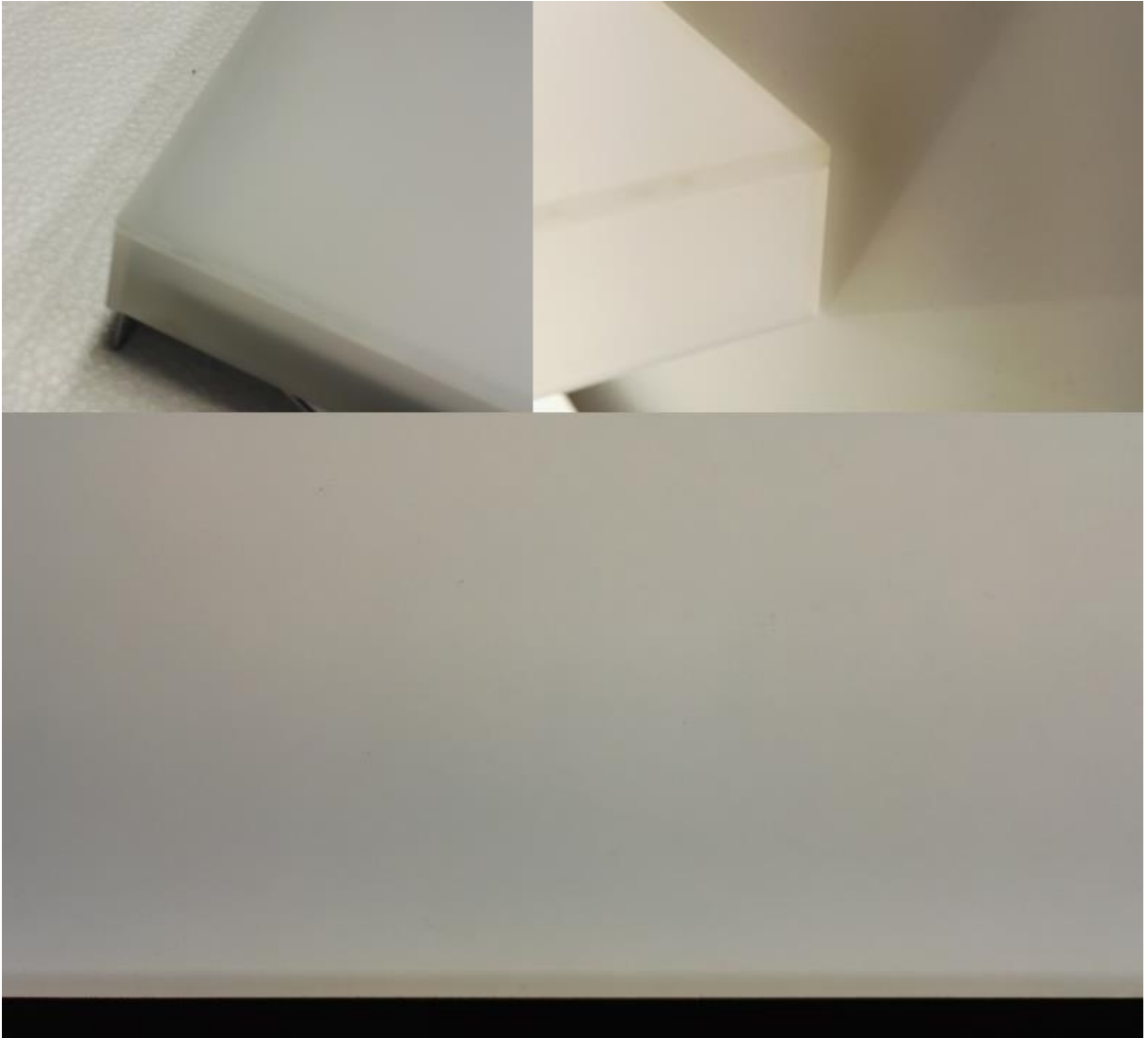
Kuva 53. Ylälaidassa kuvat liimatun akryylin nurkasta valaisemattomana ja valaistuna. Alalaidassa kuva kyseisen pinnan laidan liimaliitoksesta pinnan katselusuunnasta kuvattuna. Liimaliitoksen aiheuttaman tummemman kaistaleen leveys on 3mm eli laidan aineenpaksuutta vastaava.
