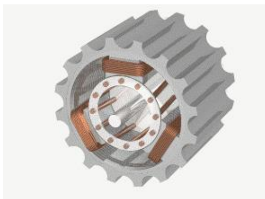
Kuva 3 Oikosulkumoottorin perusrakenne. ("Oikosulkumoottori," 2017)
