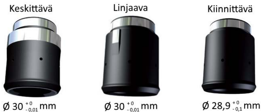
Kuva 22. Vischer & Bollin vetotappien tyypit ja halkaisijoiden toleranssit (mukaan: Vischer & Bolli 2014, s. 24).
