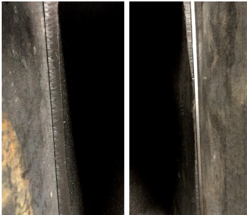
Kuva 29. Hammasakselin koneistetun hitsausrailon/olakkeen paksuuserot valussa kotelon sisäpuolelta kuvattuna.
