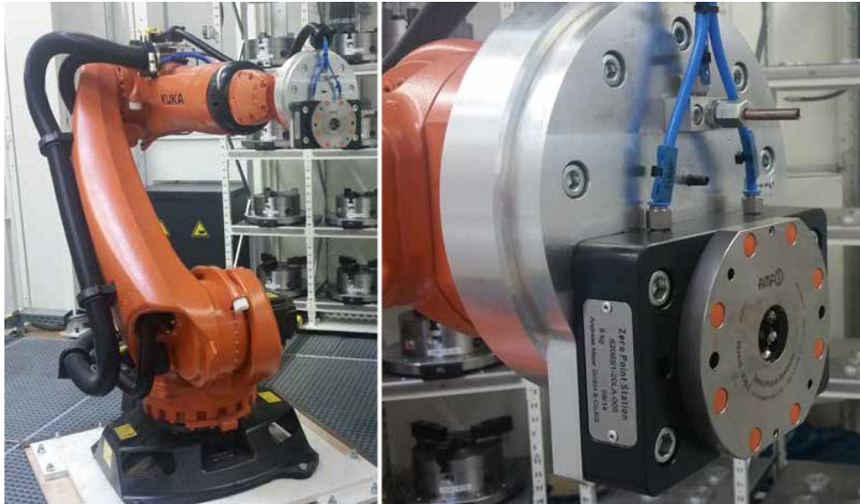
Kuva 33. Nollapistekiinnitin robotin tarraimena työstökoneen paletinvaihtajana (AMF 2017, s. 74).
