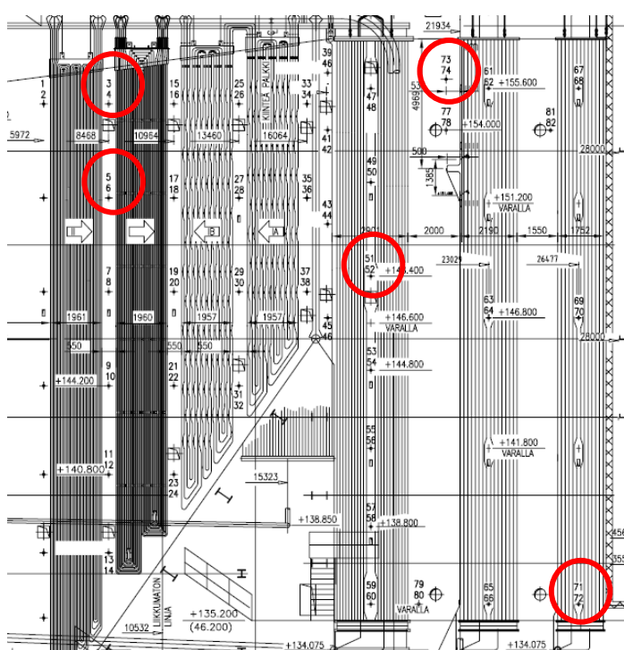
Kuva 71. Mitattavien nuohointen sijainti savukaasukanavassa
