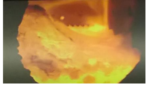
Kuva 69. Soodakattilan keon muutokset ruiskutuskokeessa
