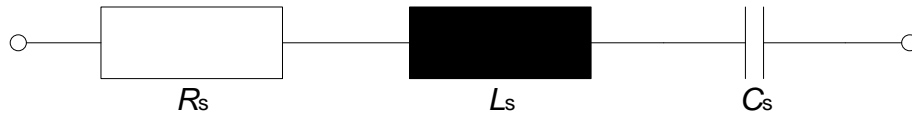
Kuva 3.2. Kondensaattorin ekvivalentti malli, jossa R_s esittää kondensaattorin sarjaresistanssia, L_s hajainduktanssia ja C_s kapasitanssia.
