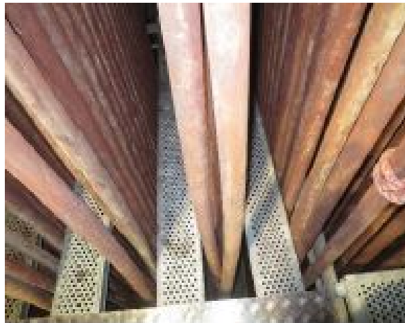
Kuva 5. Ylikuumentumisen seurauksena kaksi ensimmäistä tulistinputkea keskeltä ovat viruneet ja kattilan jäähtyessä taipuneet sivuille. (Mäkelä 2018)
