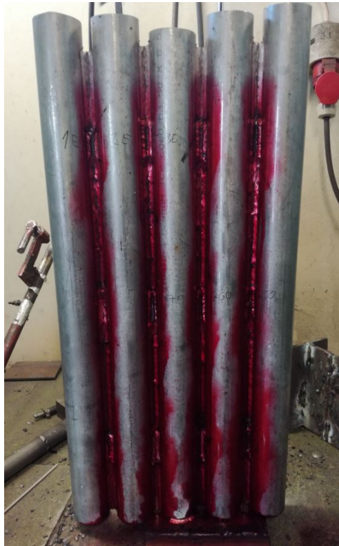
Kuva 33. Testipaneeli värjättyä tunkeumanestetarkastelua varten.
