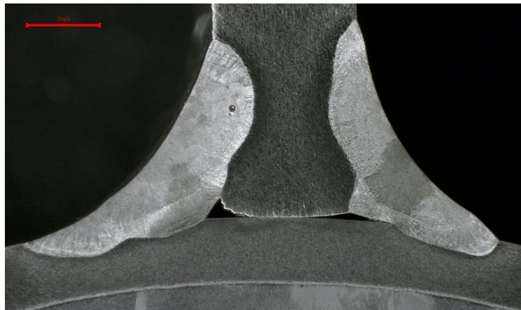
Kuva 45. Hitsauskoe 4. metallografinen makrotarkastus TIG- hitsistä, joka hitsattu 180 ampeerilla alaspäin. Kuvassa oleva mittajana on 2mm pitkä.
