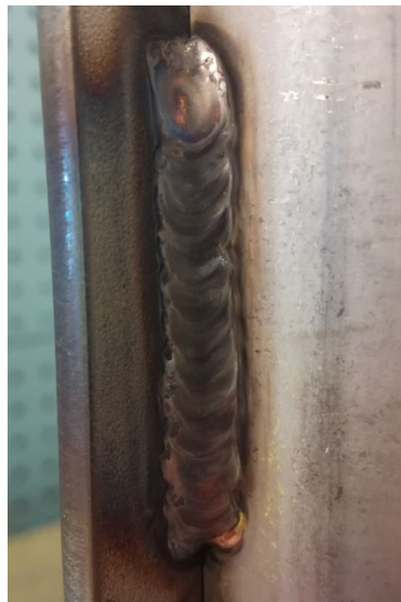
Kuva 42. Hitsauskoe 3. pystyhitsaus ylöspäin ja hitsausvirtana 180 ampeeria.
