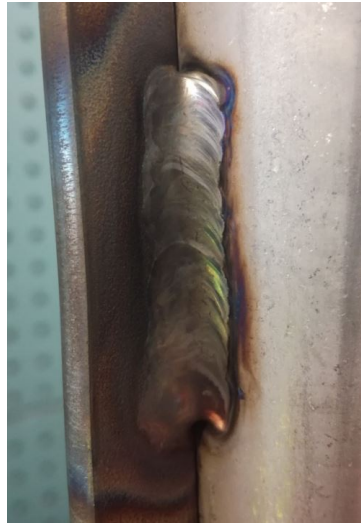
Kuva 44. Hitsauskoe 4. pystyhitsattu alaspäin ja hitsausvirtana 180 ampeeria.
