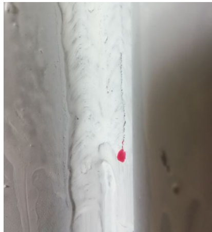
Kuva 35. Hitsauskoe 8. ei läpäissyt tunkeumanestetarkastelua.
