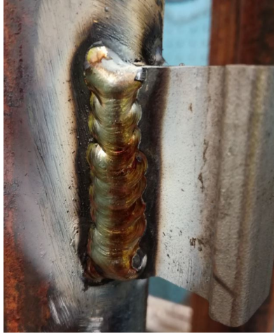
Kuva 52. Tulistimen sidehitsauskoe 5. hitsausvirtana 60 ampeeria, esilämmittämätön putki vesitäytöllä.
