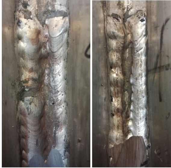
Kuva 25. Hitsauskoe 5. vasemmalla hitsattiin Lincoln Electricin lisäaineella ja 50 ampeerilla ja hitsauskoe 2. oikealla
