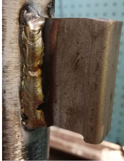
Kuva 51. Tulistimen sidehitsauskoe 4. hitsausvirtana 70 ampeeria, esilämmittämätön putki vesitäytöllä ja vasarointisuoritettu ylhäältäpäin.
