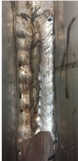
Kuva 22. Hitsauskoe 2. hitsattiin Sandvikin lisäaineella ja 55 ampeerilla
