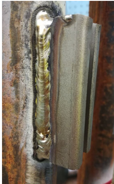
Kuva 49. Tulistimen sidehitsauskoe 3. hitsausvirtana 80 ampeeria, esilämmittämätön putki vesitäytöllä ja vasarointi suoritettu toiselta puolelta.
