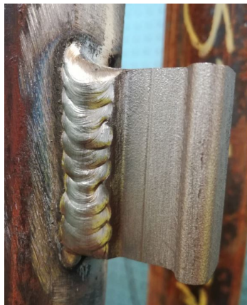
Kuva 53. Tulistimen sidehitsauskoe 6. hitsausvirtana 65 ampeeria, esilämmittämätön putki vesitäytöllä.
