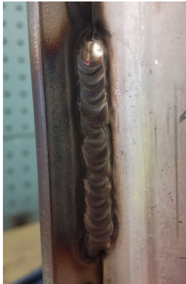
Kuva 40. Hitsauskoe 2. pystyhitsaus ylöspäin ja hitsausvirtana 150 ampeeria.
