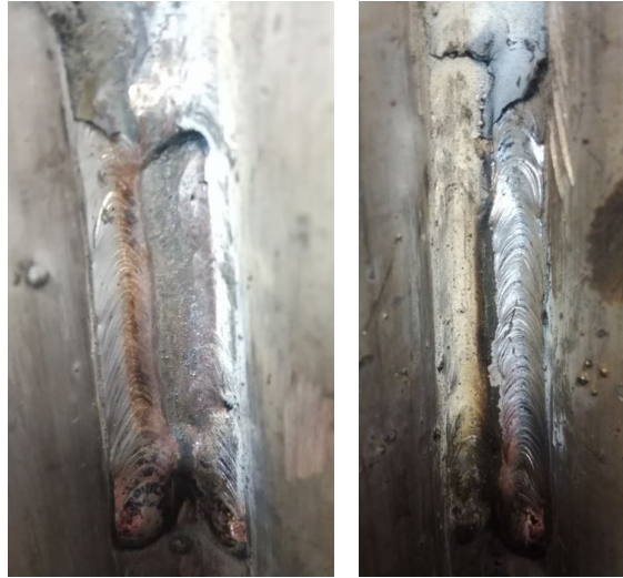
Kuva 32. Hitsauskoe 12. vasemmalla hitsattiin Lincoln Electricin lisäaineella ja 70 ampeerilla sekä hitsausasento oli alaspäin. Oikealla hitsauskoe 11.
