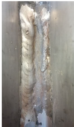
Kuva 27. Hitsauskoe 7. hitsattiin Lincoln Electricin lisäaineella ja 70 ampeerilla
