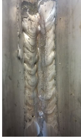
Kuva 26. Hitsauskoe 6. hitsattiin Lincoln Electricin lisäaineella ja 60 ampeerilla
