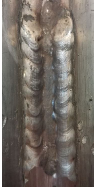
Kuva 24. Hitsauskoe 4. hitsattiin Sandvikin lisäaineella ja 60 ampeerilla. Hitsausvirta oli valittu hyvin hitsin kannalta, sillä hitsit olivat hyvin onnistuneet.
