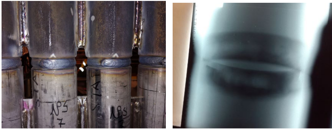
Kuva 12. Höyrystinputkienliitos tehty ympärihitsaamalla ja hitsin röntgentarkastus.
