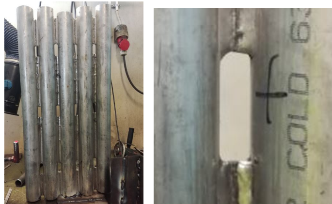
Kuva 16. Hitsattu membraaniseinä Sanicro 38 putkesta ja seostetusta 825 evämateriaalista, mikä sisälsi 12 testiaukkoa, joita hitsattiin hitsauskokeissa.
