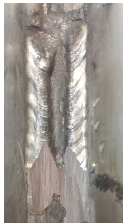
Kuva 21. Hitsauskoe 1. hitsattiin Sandvikin lisäaineella ja 65 ampeerilla. Hitsit hitsattiin käyttämällä pelkästään puikkohitsausta.
