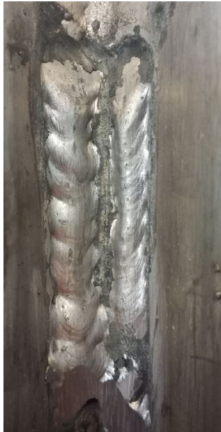
Kuva 23. Hitsauskoe 3. hitsattiin Sandvikin lisäaineella ja 70 ampeerilla
