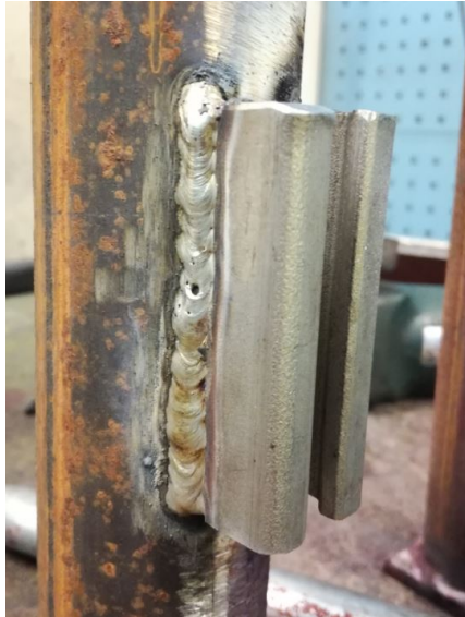
Kuva 47. Tulistimen sidehitsauskoe 1. hitsausvirtana 70 ampeeria, esilämmitetty putki ilman vesitäyttöä ja vasaroitu ylhäältäpäin.
