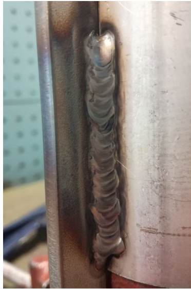
Kuva 38. Hitsauskoe 1. pystyhitsauksessa ylöspäin ja hitsausvirtana 120 ampeeria.
