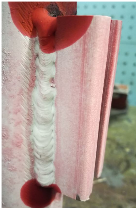
Kuva 48. Tulistimen sidehitsauskoe 2. hitsausvirtana 75 ampeeria, esilämmitetty putki vesitäytöllä sekä tunkeumanestetarkastelulla.
