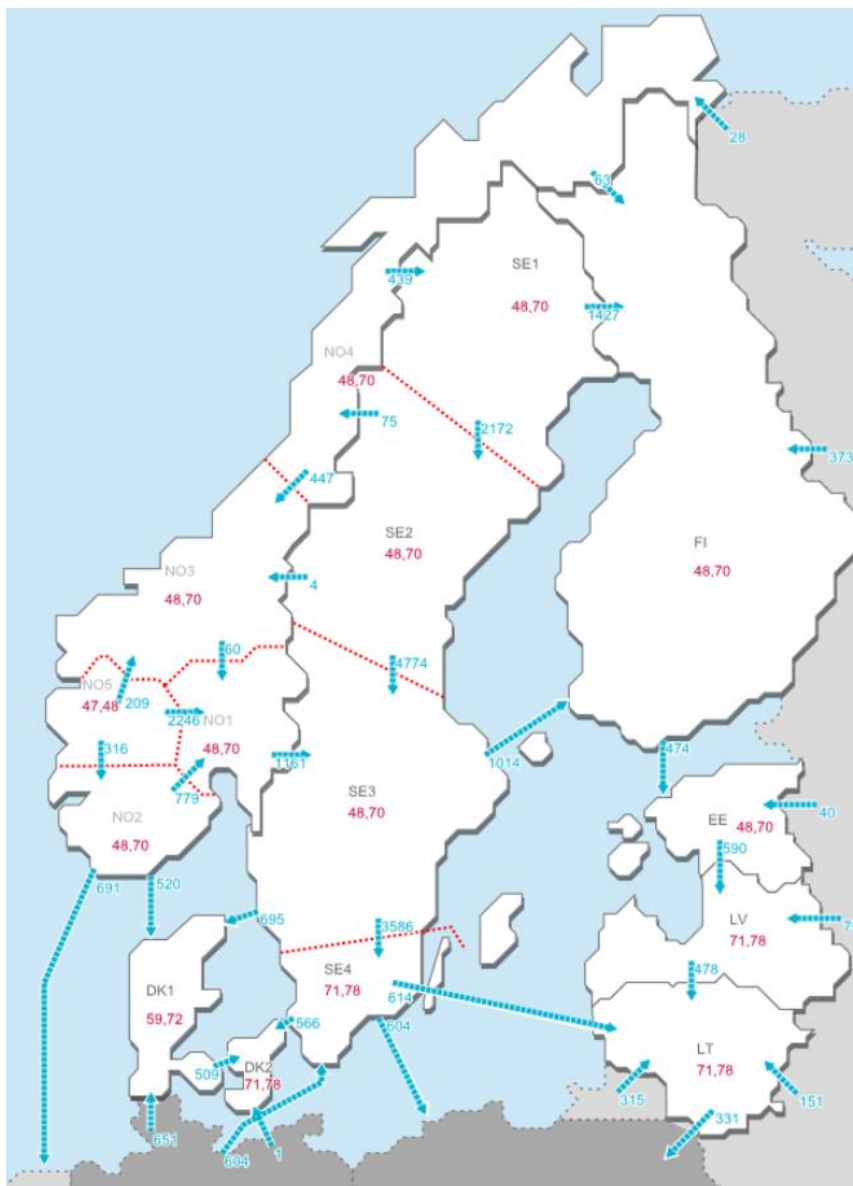
Kuva 4 Pohjoismaisen sähkömarkkinan hinta-alueet. Kuvasta nähdään aluehinnat [€/MWh] sekä alueiden välisten siirtojen määrät [MW] 27.6.2018 klo 15:00 (Statnett, 2018)
