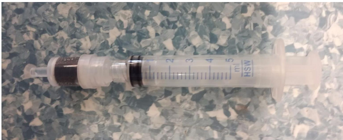
Kuva 6 Dionex OnGuard II H 1cc patruuna ja viiden millilitran näyteruisku.
