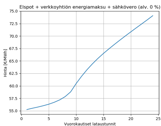
Kuva 3.3 Vasemmalla Suomen alueen Elspot-hinnasta, sähköverosta ja Lappeenrannan Energiaverkot Oy:n keskijännitetehtönsiirron energiamaksuista muodostuvan sähkön keskimääräinen hinta vuosien 2013-2018 perusteella halvimpien vuorokautisten lataustuntien funktiona. Oikealla yöllä ja päivällä tapahtuvien lataustuntien vertailu eri lataustuntimäärillä, kun päivä on klo. 7-22 ja yö klo. 22-7.
