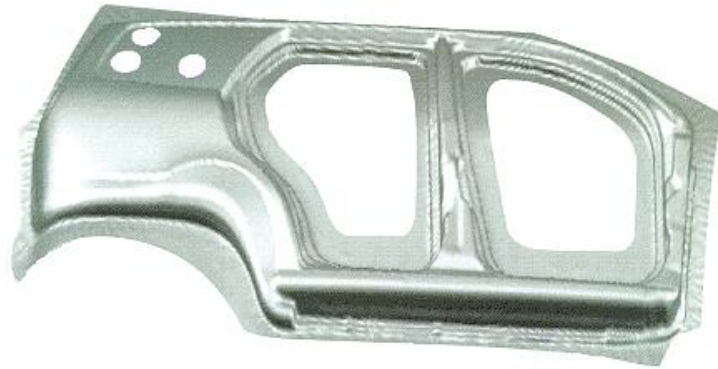
Kuva 41. Simuloinnin avulla toteutettu vaikea syvävetokappale. /50/.
