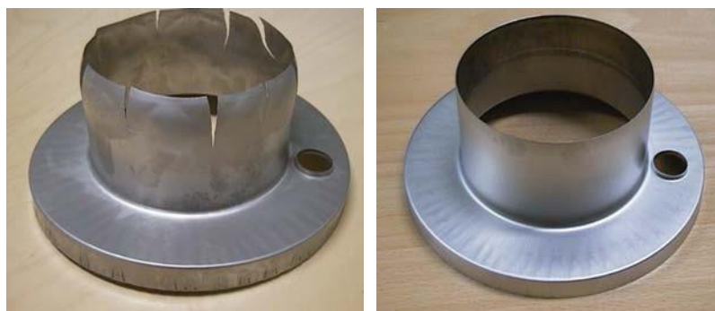
Kuva 43. Syvävetomateriaali AISI 316L 0,5 mm. Kuva 44. Syvävetomateriaali AISI 316L 0,6 mm. Kappale Ø 100 mm Iris kansi.
