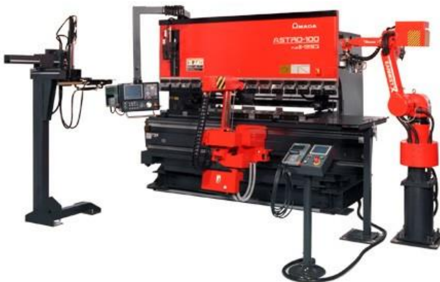
Kuva 21. Robotisoitu särmäyssolu. Erilliset särmäys- ja kappaleenkäsittelyrobotit. /59/.
