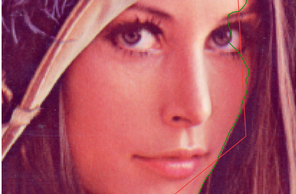
Kuva 30: Parametroidun käyrän siirtyminen Active Contour -menetelmällä. Lähtötilanne punaisella, vihreä on 19 iteraation jälkeen, \alpha = 0.3 , ja \beta = 0.2 .
