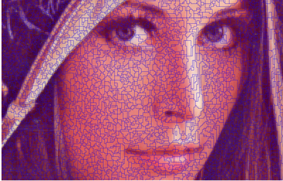
Kuva 27: Watershed-muunnoksella saadut reunaviivat. Kuvasta näkyy voimakasta ylisegmentointia ja prosessointialueiden välinen raja ennen alueiden uudelleennimiöimistä.
