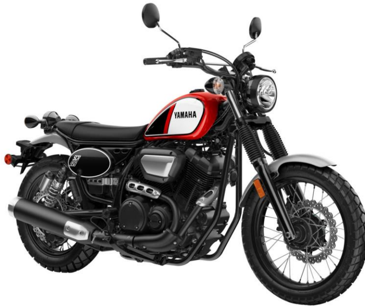
Kuva 3. Yamaha SCR950 hyödyntää kaksoikehtorunkoa (Yamaha Motor Europe N.V. 2019a).
