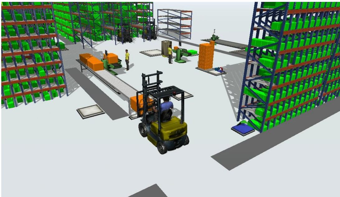
Kuva 20. Vastapainotrukki täyttämässä rullarataa materiaalivarastossa
