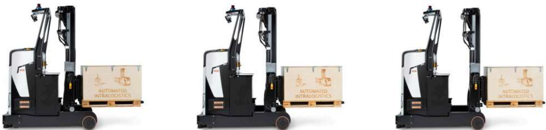
Kuva 1. Työntömastotrukki on saanut nimensä maston työntöliikkeestä. Kuvassa RoclA Automated Reach Truck (ART). (RoclA AGV. 2020.)
