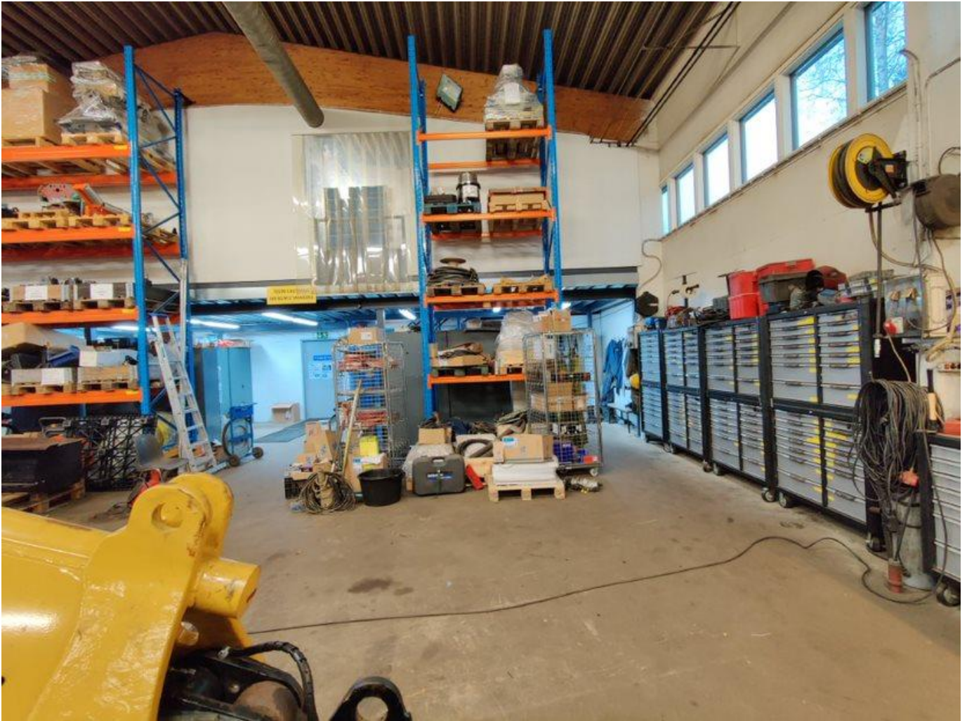
Kuva 6. Paketteja ja työkaluja on lattialla estäen pääsyn kuormalavahyllyyn, lisäämässä tapaturmariskiä, sekä tavaroiden vahingoittumisriskiä.
