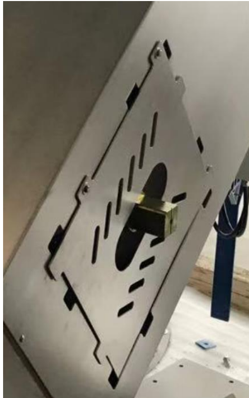
Kuva 45. Uuden vivustosuojan huoltoluukku.
