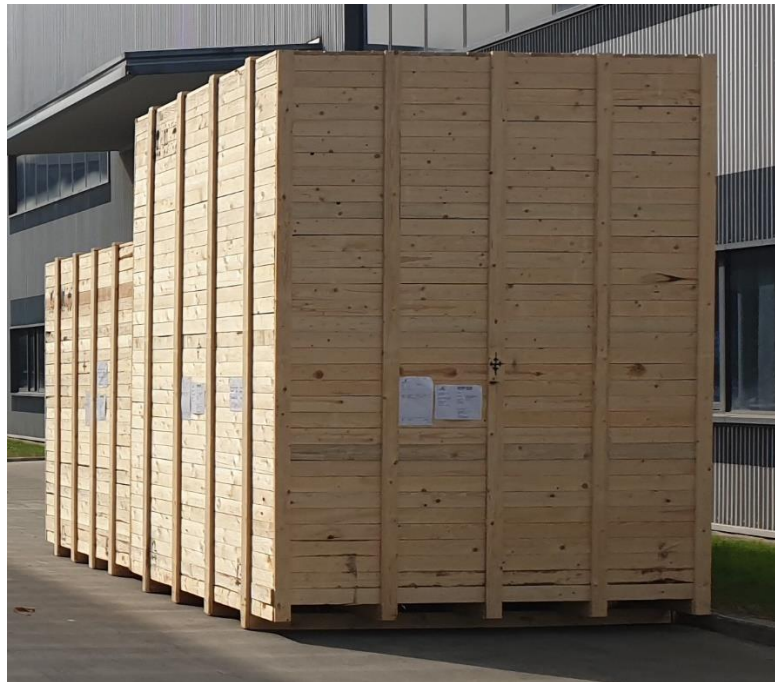
Kuva 30. Pakattu 3-tiepelti, puisen kuljetusalustan ympärille asennettu seinät ja katto.
