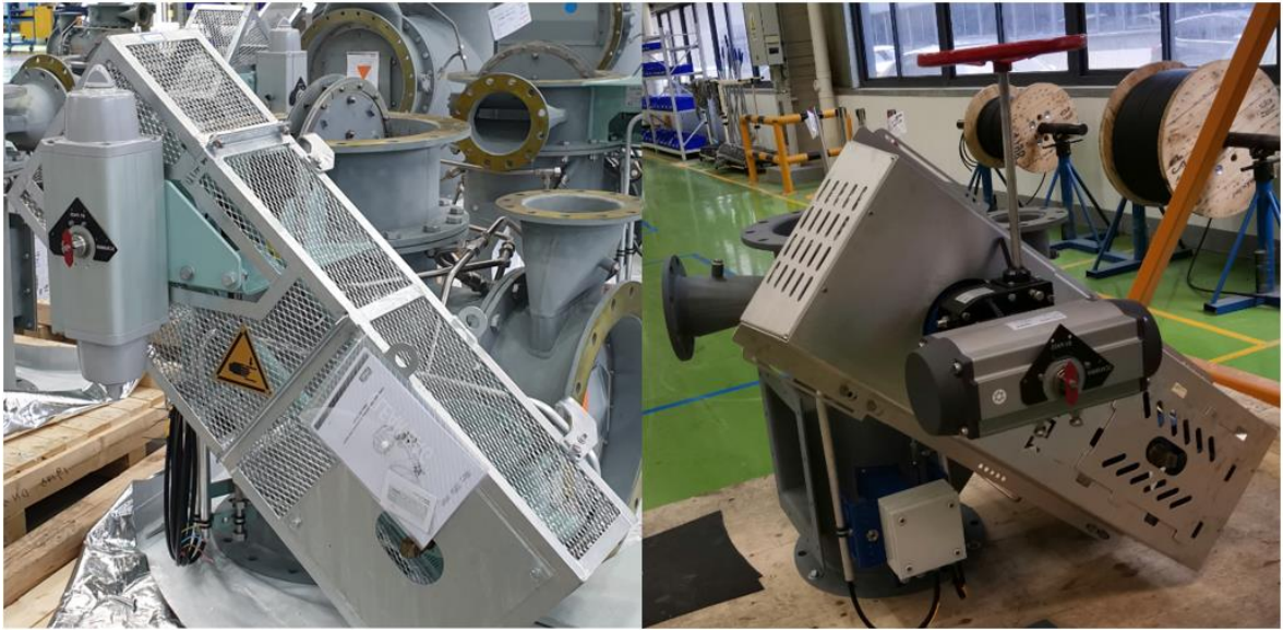
Kuva 32. Sammet DN350 3-tiepelti kokoonpano vasemmalla vanha ja oikealla uusi malli
