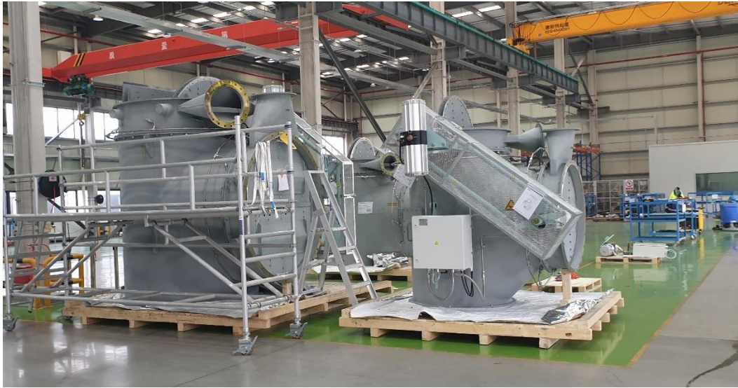
Kuva 27. 3-tiepeltien kokoonpanolinja ja pakkausalusta.
