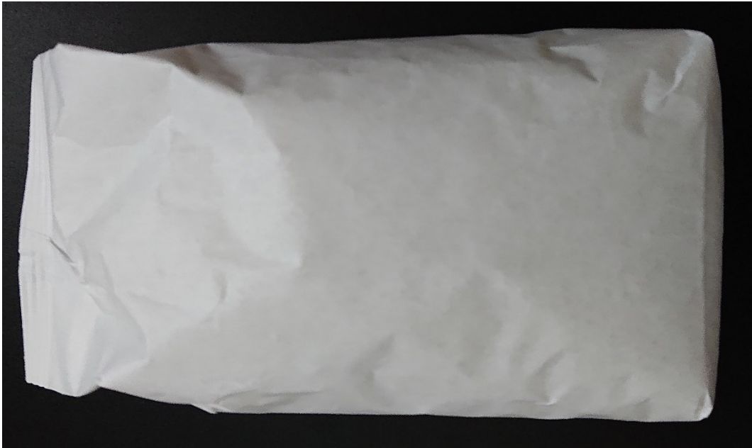
Kuva 13. Muodostus-täyttö-suljentalaitteistolla valmistettu pussipakkaus
