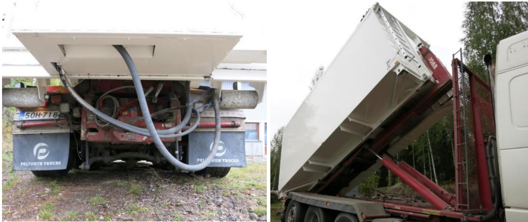
Kuvat 4 ja 5 Vasemmalla hakepuhaltimesta lähteviä hydrauliletkuja ja oikealla hytin takana oleva öljysäiliö.
