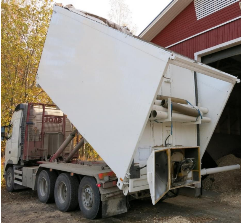
Kuva 22 Lämpösi Oy:n hakepuhallin JYJ600 asennettuna KOME COMPOSITE -kuljetuskonttiin.
