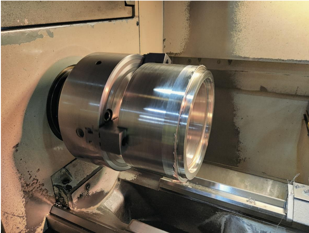
Kuva 7. Testikappale kiinni DUSin sorvissa.
