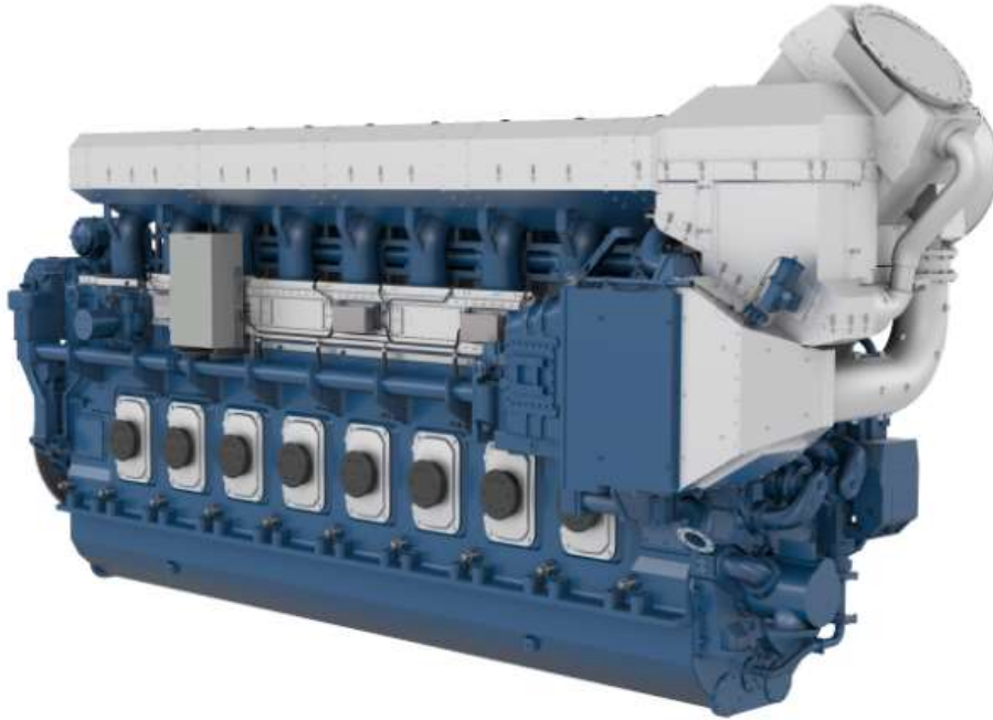
Kuva 33. Mein Schiff 1 risteilyaluksessa käytettävä Wärtsilä 46F 4-tahtimootori (saatavuus: 7.2 MW – 19.2 MW) joka toimii HFO:lla, MDO:lla tai kevyellä polttoöljyllä. (Wärtsilä, 2021)
