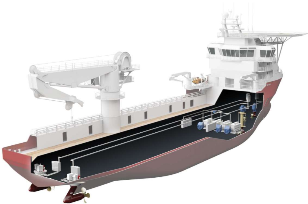
Kuva 2. LVDC-sähköjärjestelmä toteutettu Dina Starissa ABB:n toimesta (ABB, 2021).
