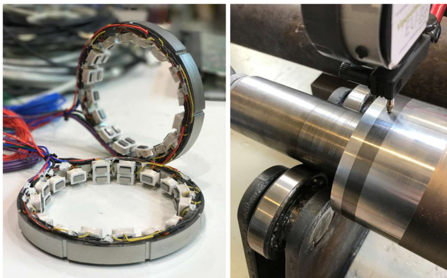
Kuva 2.10 Artikkelin induktiivinen paikka-anturi, jolla voidaan mitata poikkeamaa radiaalisesti ja akselin suunnassa. Staattorikappaleessa (kuva vasemmalla) on käämitettyjä napapareja kolmessa rivissä. Etu- ja takarivin napapareilla mitataan akselin suuntaista paikkaa ja keskimmäisillä mitataan paikkaa radiaalisuunnassa. Roottorissa (kuva oikealla) on ferromagneettista terästä oleva alue ja ympärillä on ei-magneettista alumiinia. (Sillanpää et al. 2021)
