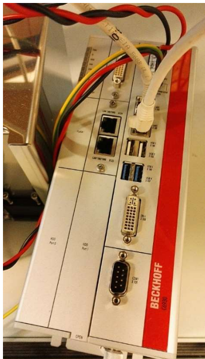
Kuva 3.8 Beckhoffin C6930 teollisuus-PC, jossa testilaitteiston säätöalgoritmit toteutetaan.
