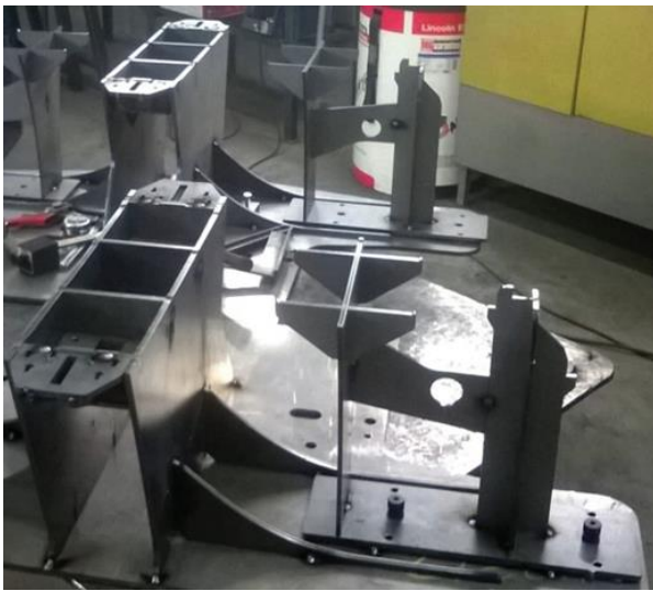
Kuva 16. Levyleikkeiden käyttö hitsauskiinnittimissä (Solehmainen et al. 2016, s. 41).
