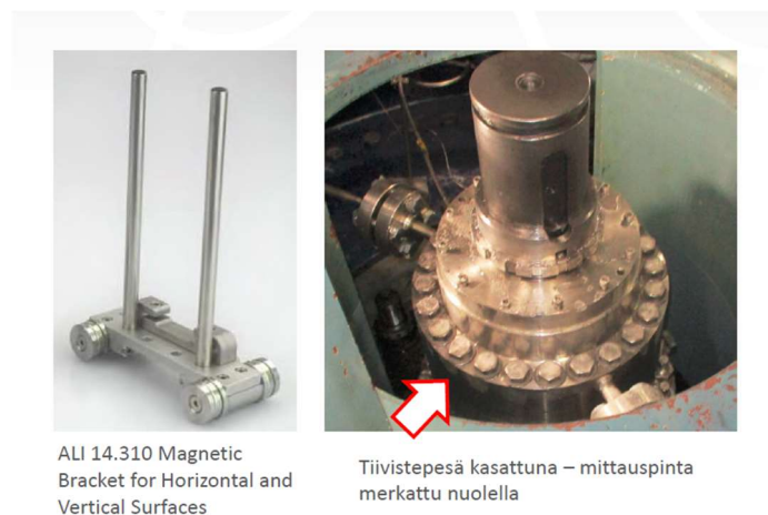
Kuva 17. Mittausanturin kiinnike ja mittakohta moottorinvaihdon yhteydessä (Ritvanen 2022, 7).
