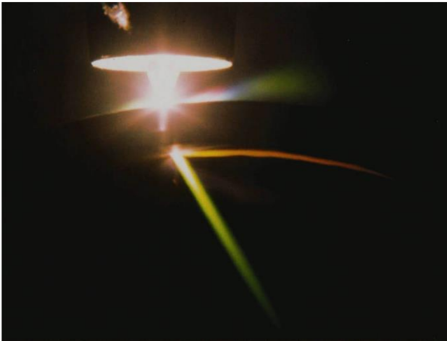
Kuva 4. Sivukuva keyhole TIG-hitsauksesta (mukaiillen: Jarvis 2001, s. 39).
