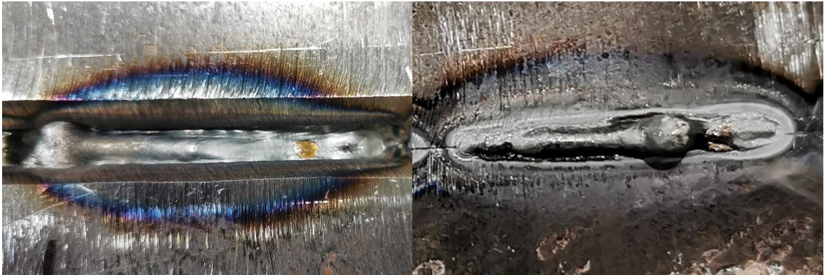
Kuva 22. Hitsin pinta ja juuri, kun sula romahti (405 A ja 15,3 V).
