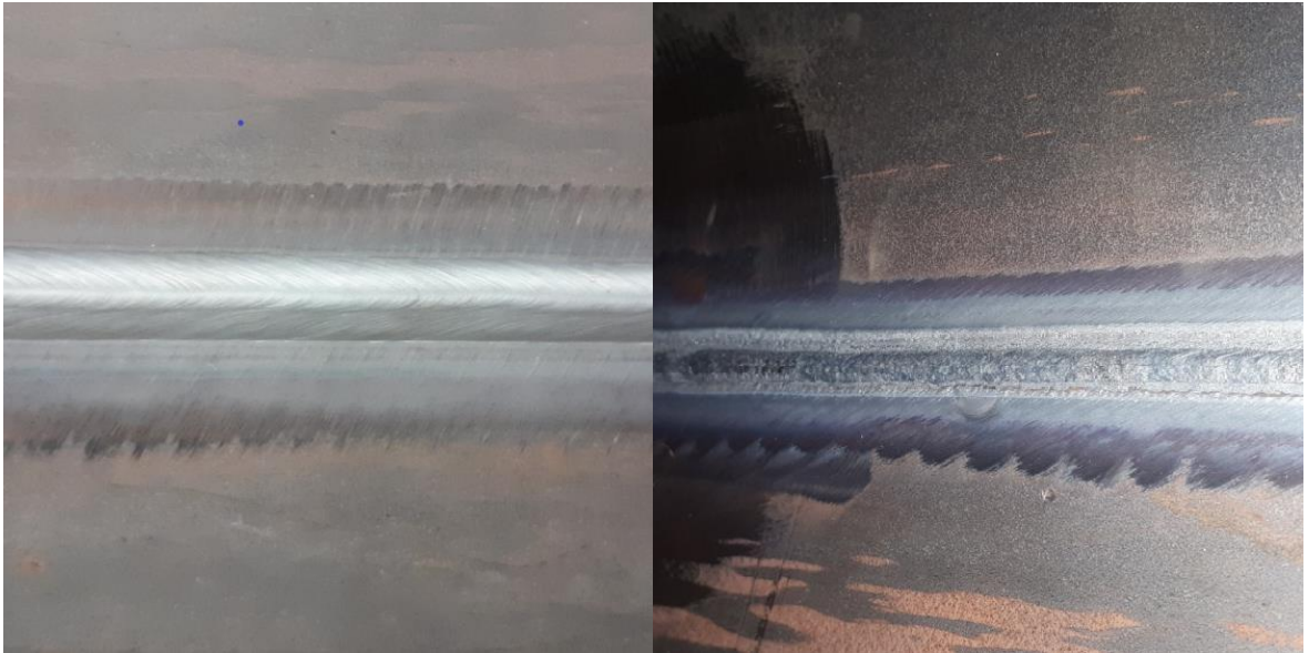
Kuva 14. Fronius ArcTig: hitsin pinta ja juuri (mukaillen: Lehtomaa 2022a).
