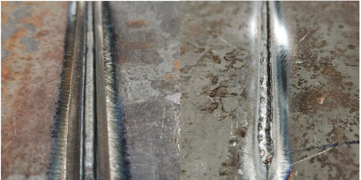
Kuva 23. P355NL2 onnistuneen hitsin pinta ja juuri.
