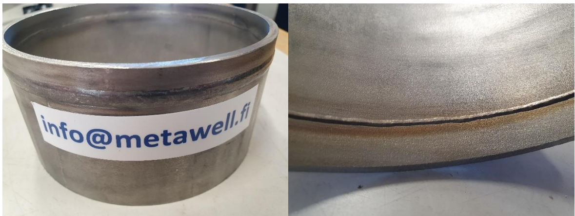
Kuva 10. EWM forceTIG: putken kehähitsi.
