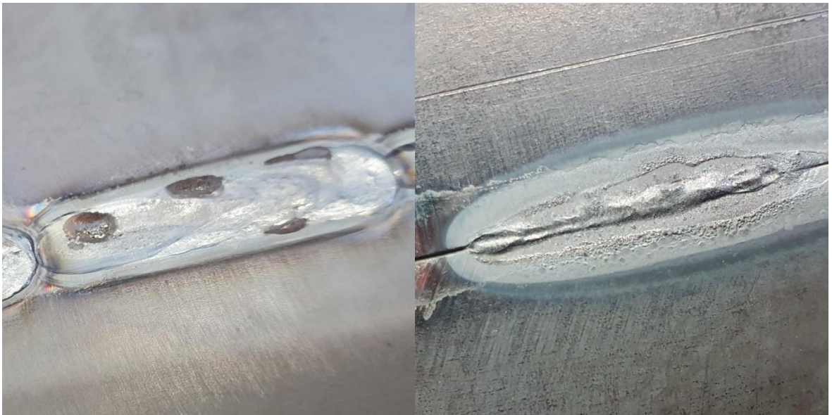
Kuva 18. Hitsin pinta ja juuri hitsatessa ilman juurikaasua.
