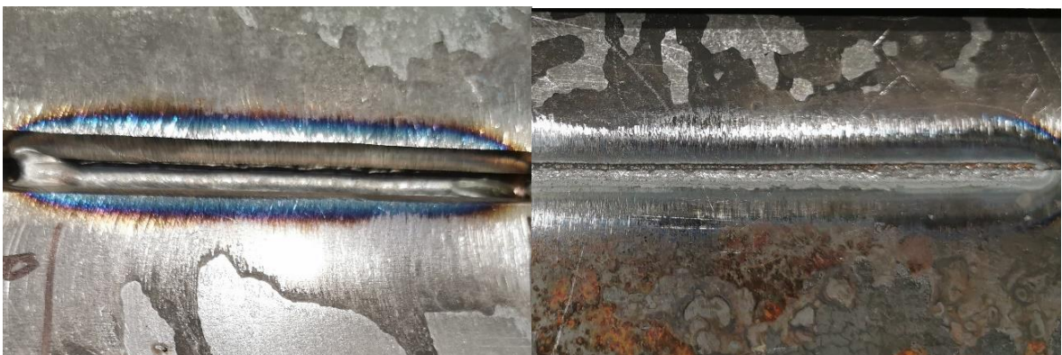
Kuva 21. Hitsin pinta ja juuri, kun keyhole muodostui (350 A ja 13,4 V).
