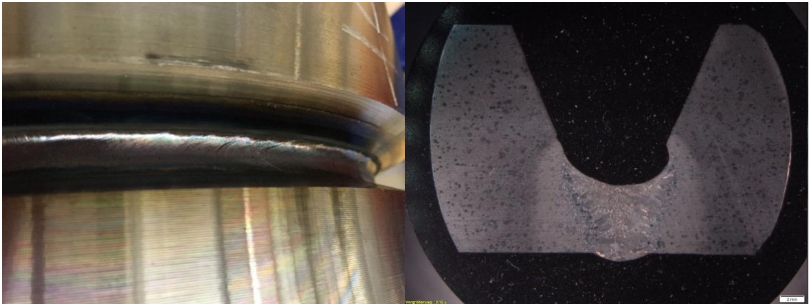
Kuva 12. Fronius ArcTig: hitsi ja makrohie (mukaillen: Lehtomaa 2022b).
