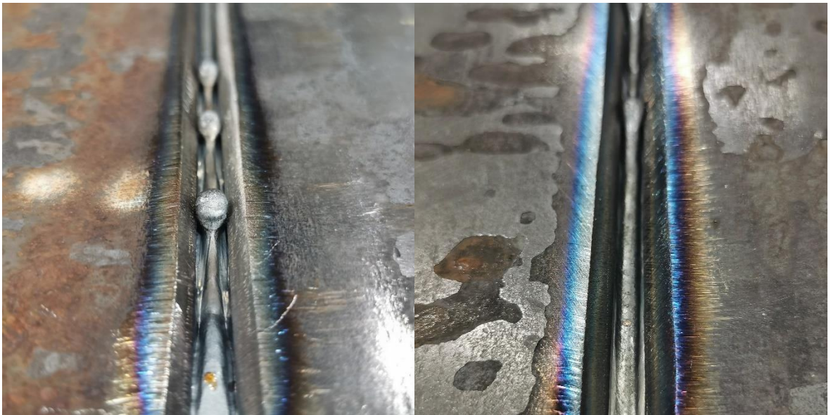
Kuva 24. P355NL2 hitsiin syntynyt epämuodostuma.
