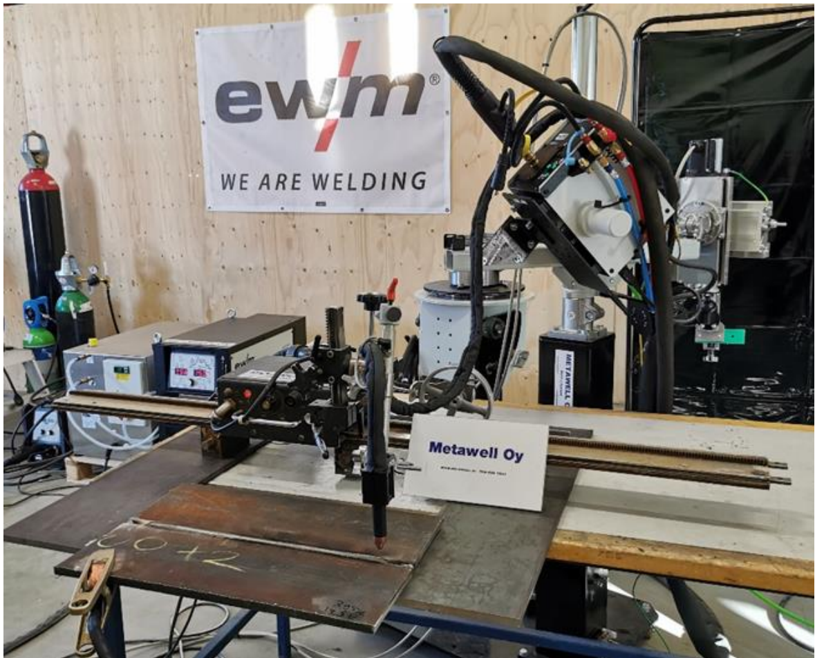
Kuva 16. Hitsauskokeessa käytetty EWM forceTig-laitteisto.
