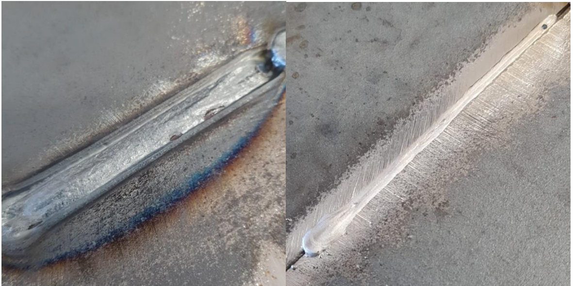
Kuva 17. Hitsin pinta ja juuri käytettäessä 100 % argonia juurikaasuna.
