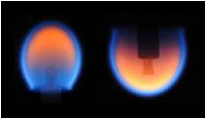
Kuva 2. Kynttilän liekki mikropainovoimassa sytytyshetkellä (NASA, 2014a)
