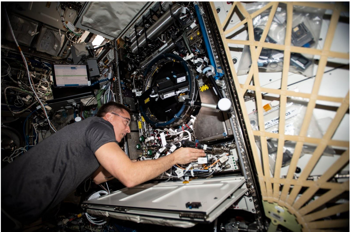
Kuva 11. CIR-mittauslaitteisto ja sen keskellä oleva sylinterin muotoinen polttokammio (Glenn Research Center, 2021a)
