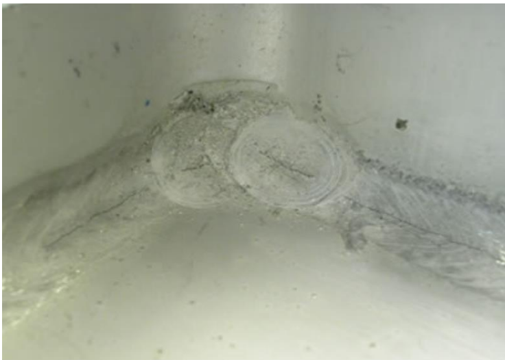
Kuva 3. Kraaterihalkeamia hitsin päätössä, sekä halkeamia hitsin keskellä (Esabna 2022).
