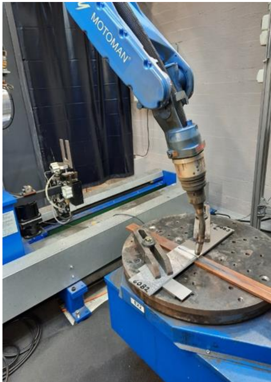
Kuva 11. Hitsauksen koejärjestely, Motoman EA1900N-hitsausrobotti, koekappaleen alla juurituki.
