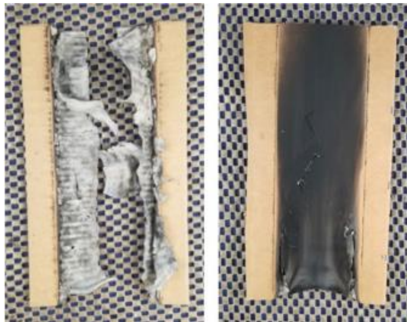
Kuva 9. Aaltopahvinäytteet VBT testien jälkeen. Vasemmalla pinnoittamaton näyte, ja oikealla PVA/MMT pinnoitettu (mukaihen Williams et al., 2021)
