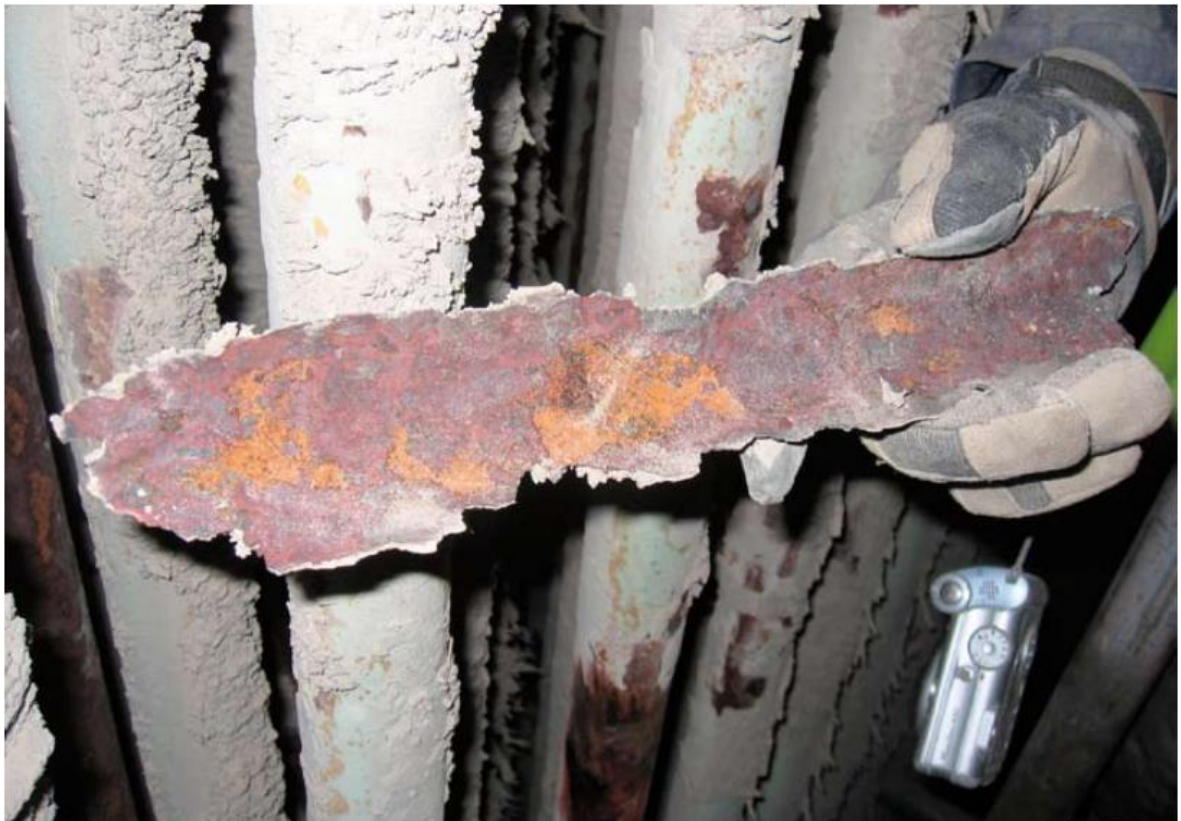
Kuva 3. Helposti lohkeava sakkakerros on usein merkki alkavasta kloridikorroosiosta. (Klarin, 2009, p. 28)
