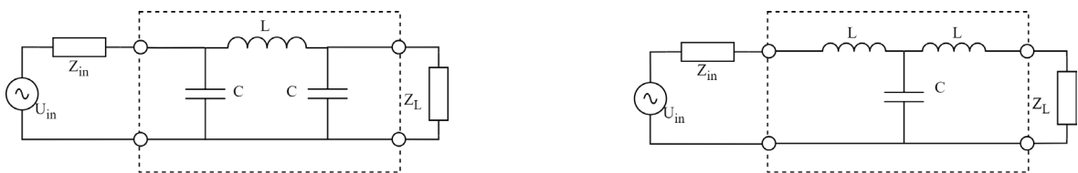
Kuva 3.3. \pi -suodatin ja T-suodattimet, joiden teoreettinen maksimivaimennus on 60dB/dekadi (mukaillen Joffe, Lock, 2011, 591–600)
