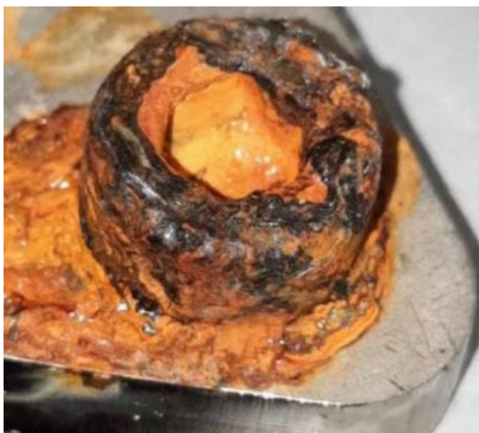
Kuva 8. Galvaaninen pari ruuvikiinnityksessä. (Teräsrakenne 2021, s. 42.)
