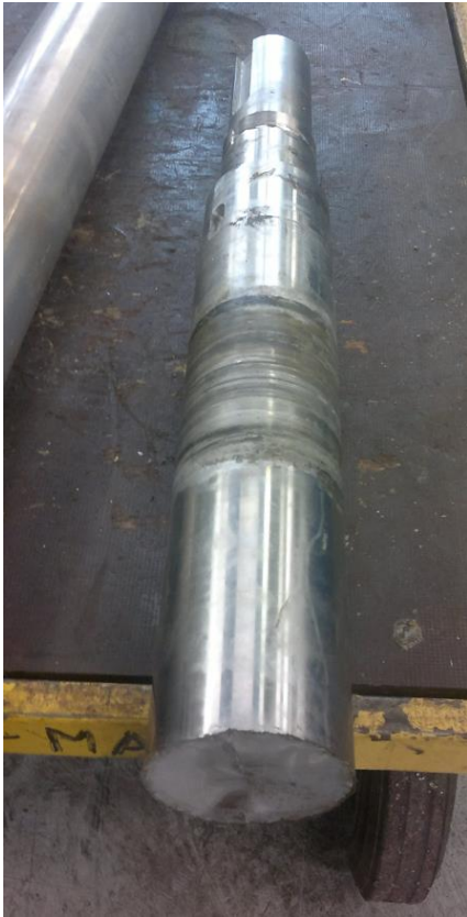
Kuva 12. Syklisen kuormituksen johdosta katkennut pumpun akseli
