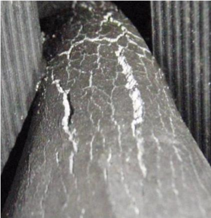
Kuva 13. Virumisen seurauksena särkynyt putki. (Yara International ASA 2022c, s.13.)
