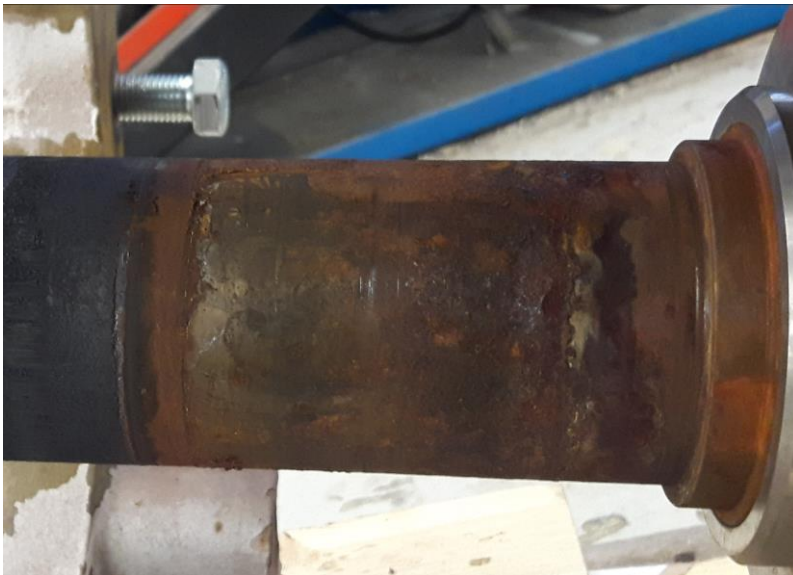
Kuva 7. Rakokorroosiota akselissa, akselin päällä on ollut soviteholkki
