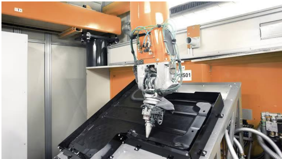
Kuva 8. Mercedes-Benz autojen muovisen komponentin laserleikkaus (KUKA, 2023)
