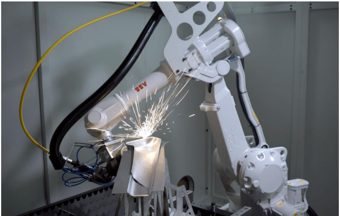
Kuva 6. ABB:n 6-akselinen nivelsiirrobotti laserleikkaussoulussa. (BLM Group, 2020b)
