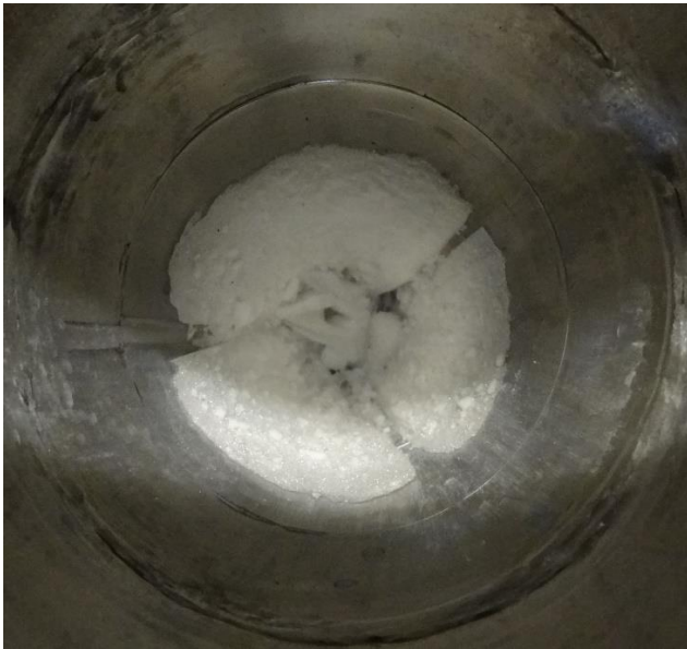
Kuva 4. Hiilidioksidijää kappaleita syklonin sisällä
