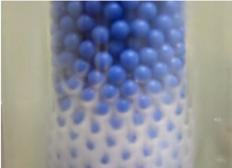
Kuva 14. Täytekappaleiden pintaan muodostunutta hiilidioksidijäätä(Tuinier et al., 2010, p. 117)
