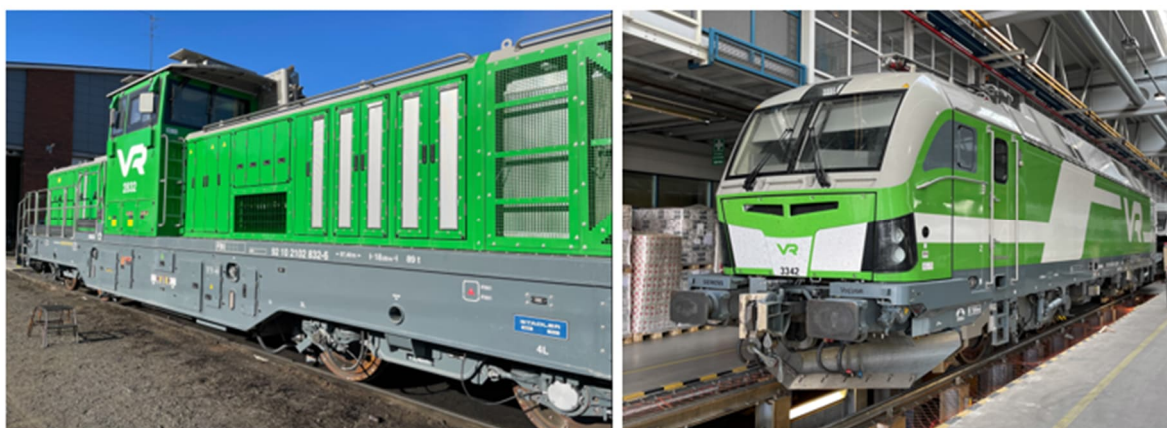
Kuva 3. Vasemmalla kuvassa Dr19 tyypin dieselsähköinen veturi ja oikealla Sr3 tyypin sähköveturi.
