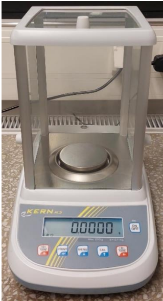
Figure 12. Analytical balance ALS (Kern, Germany).
