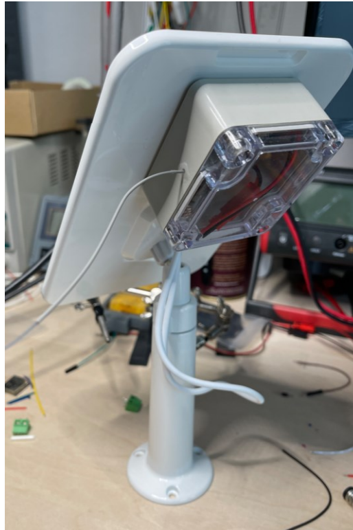
Kuva 12. Mittauslaite kiinnitettynä Reolink-aurinkopaneelin runkoon.
