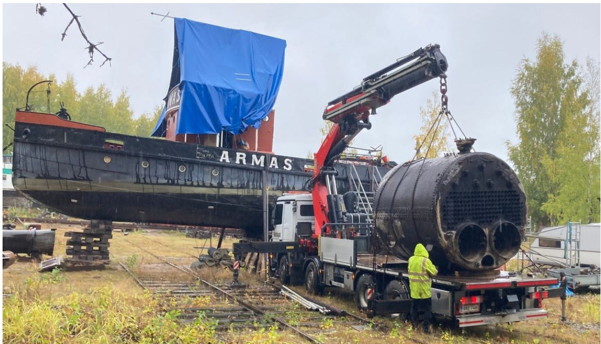
Kuva 1. Höyrylaiva Armas ja korjattava höyrykattila (Reunanen 2023).
