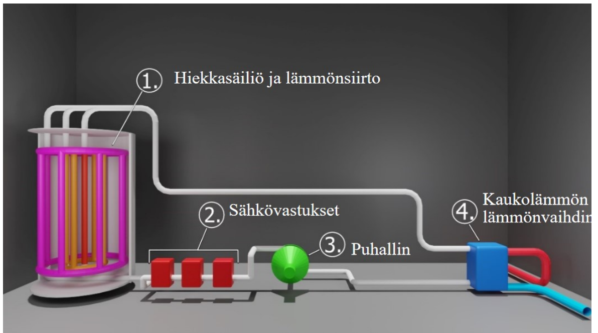
Kuva 19. Hiikkavaraston komponentit (Hurttila, E. 2022)
