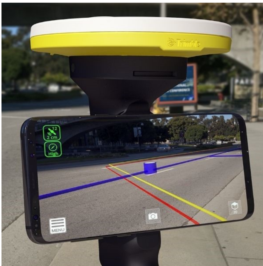
Kuva 21. SiteVision näkymä Trimble NIS järjestelmässä. (Trimble SiteVision 2021)
