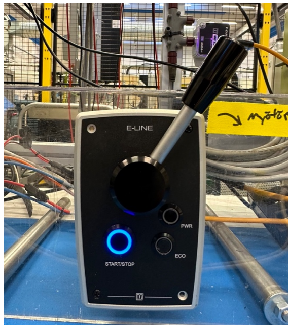
Kuva 6. Vetus E-Line -voimalinjan kahvamuoduli, eli ns. paaki
