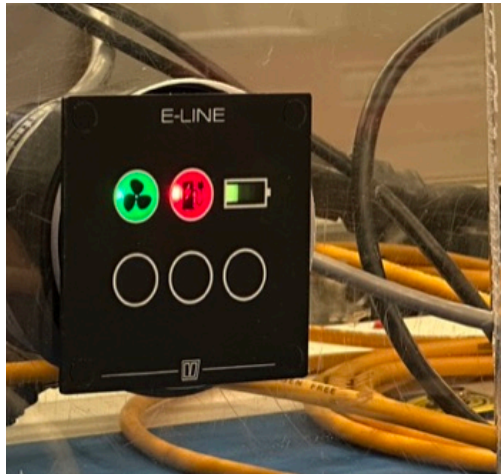
Kuva 7. Merkkivalopaneeli, kun jännite ohjekirjan mukaan \pm 40\text{--}50\%
