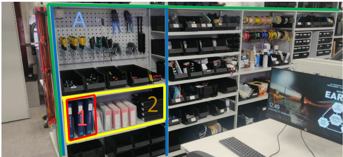
Kuva 4, Kuvassa on vihreällä merkitty varastohylly, sinisellä hyllyväli, keltaisella taso ja punaisella paikka tasolla
