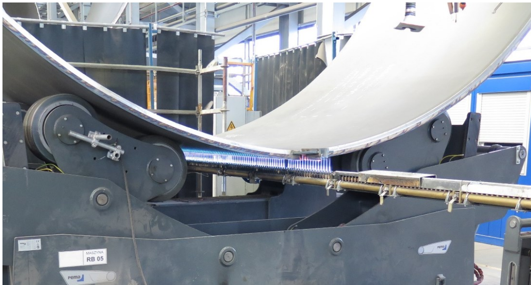
Kuva 7. Kaasutoiminen esilämmitysmenetelmä lieriökappaleen pituussauman hitsauksessa (Pemamek 2015, Pemamekin kuvapankki)
