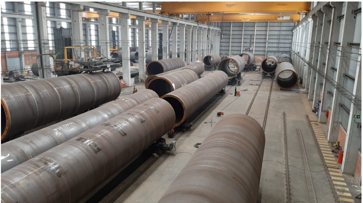
Kuva 2. Osa Pemamekin toimittamaa tuotantolinjaa. Vasemmassa reunassa nähtävissä ulkopuoliseen kehäsaumahitsaamiseen suunniteltu PEMA WS2 (Welding station 2) (Pemamek 2023, Pemamekin kuvapankki)
