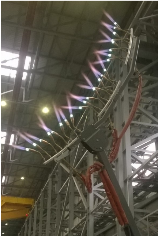
Kuva 9. Paineilma-asetyleenillä toimiva 24:n polttimen lieriökappaleen kehäsauman esilämmityslaite (Pemamek 2015, Pemamekin kuvapankki)
