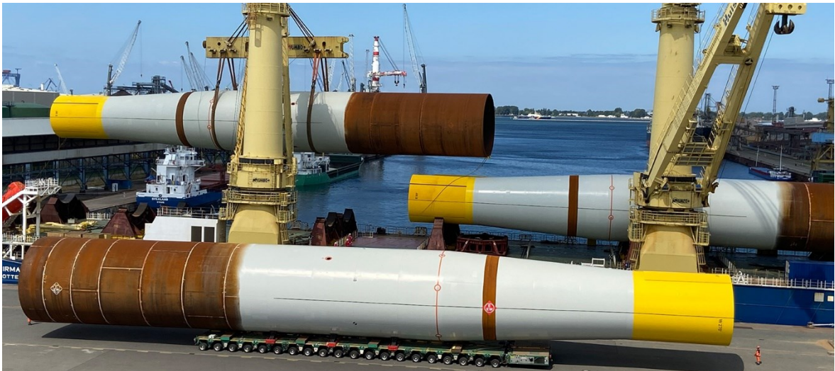
Kuva 3. Valmiita monopile perustuksia (EEW Group 2023)
