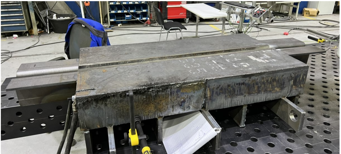
Kuva 19. Esilämmitystutkimuksien testikappale, kooltaan 1010x545x150 mm (hitsausrailo- jen päädyissä olevia satelliittipaloja ei huomioitu)
