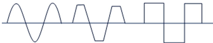
Kuva 14. Siniaalto, trapetsiaalto ja kanttiaalto (Mohanty & Sharma 2021)
