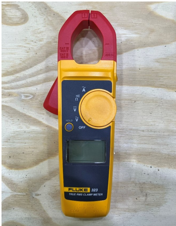
Kuva 25. Sähkönsyötön mittauksissa käytetty pihtimittari Fluke 323
