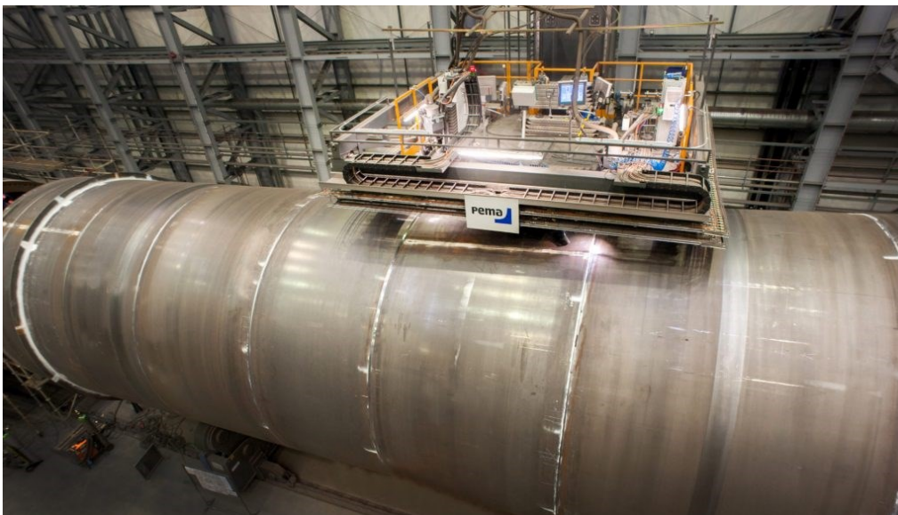
Kuva 6. PEMA WS2 hitsaustaso hitsaamassa ulkopuolista kehäsaumaa kahdella hitsauspäällä samanaikaisesti (Pemamek 2023, Pemamekin kuvapankki)
