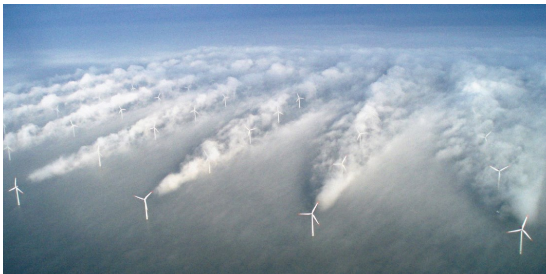
Kuva 2.12. Tuulivoimalaitosten tuottamia pyörrevanoja (Vattenfall 2023)
