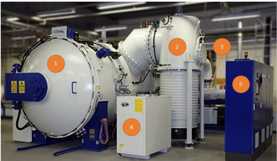
Kuva 9. Tyhjöuunin pääkomponentit: Uunikammio (1), tyhjöjärjestelmä, jossa mekaaniset pumput (3) esityhjön tuottamiseen sekä korkean tyhjötason mahdollistava diffuusiopumppu (2) varustettuna erillisellä jäähdytysjärjestelmällä (4) ja tyhjöuunin ohjausyksikkö (5)
