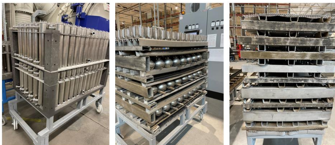
Kuva 20. Loval Oy:n juotoskuormakokoonpanoja
