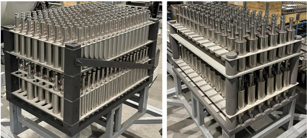
Kuva 22. Uunikuormat hiilikuitu- ja grafiittirunkorakenteella
