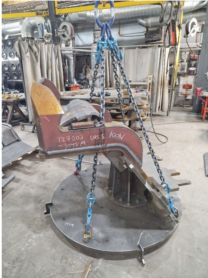
Kuva 13. Hitsauskiinnittimeen asennettu lastauskoneen eturungon alaosan hitsauskokoonpano.
