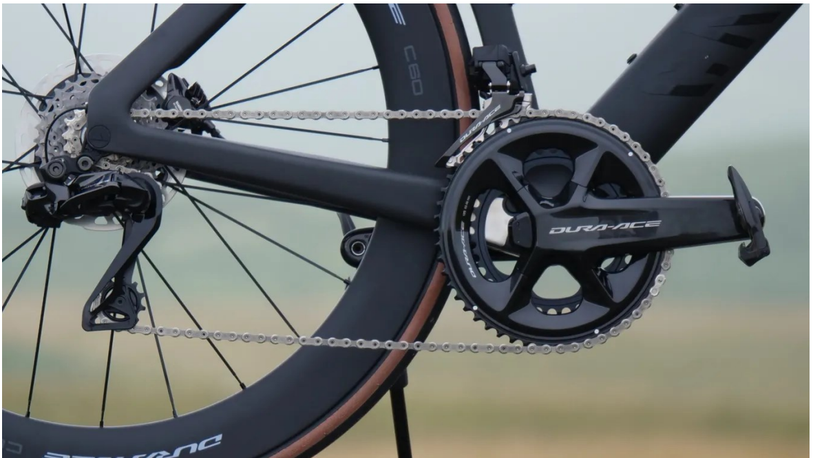
Kuva 1. Shimano Dura-Ace Di2 voimansiirto (Hallam-Gravells 2023)
