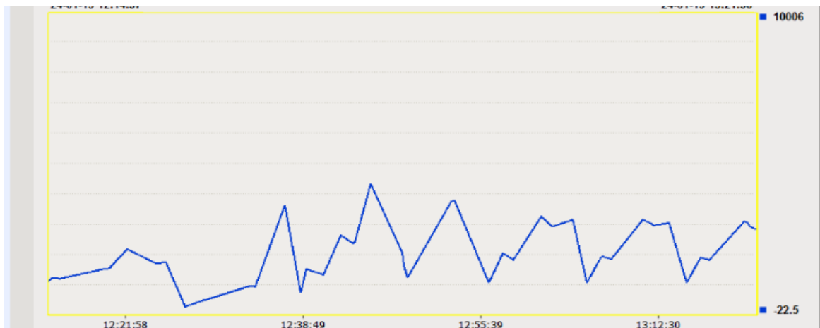
Kuva 54. Kattilan epätasainen kuormitus.
