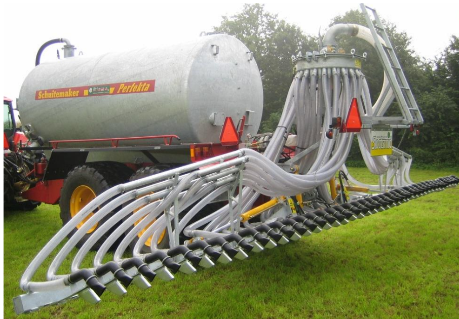
Kuva 32. Vannasmultaimella (matalamultain) varustettu lietelantavaunu. (Laakson Metalli Oy 2007a)
