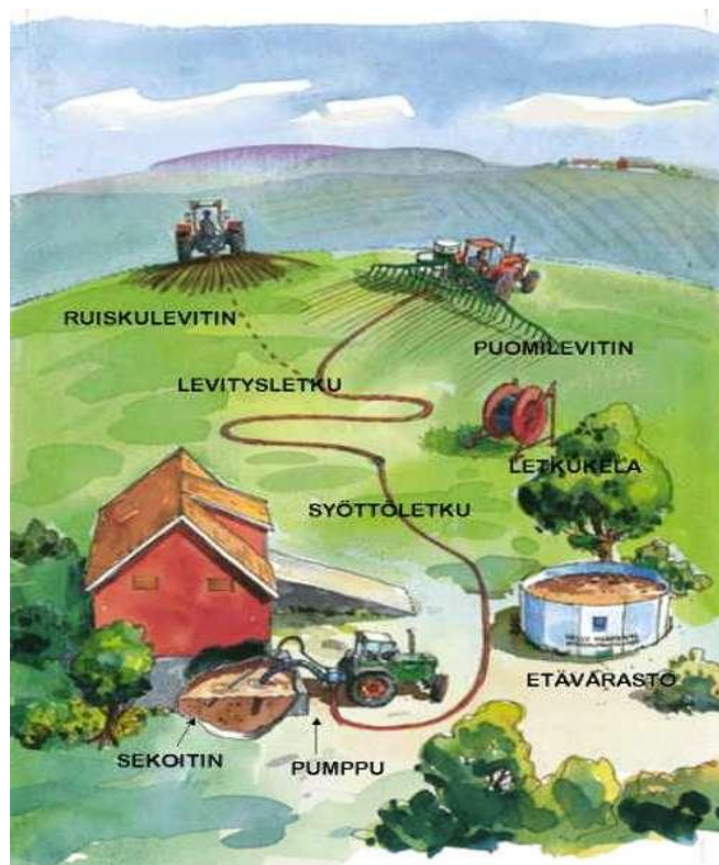
Kuva 27. Syöttöletkumenetelmän periaatekuva. (Agromiljø As 2007)
