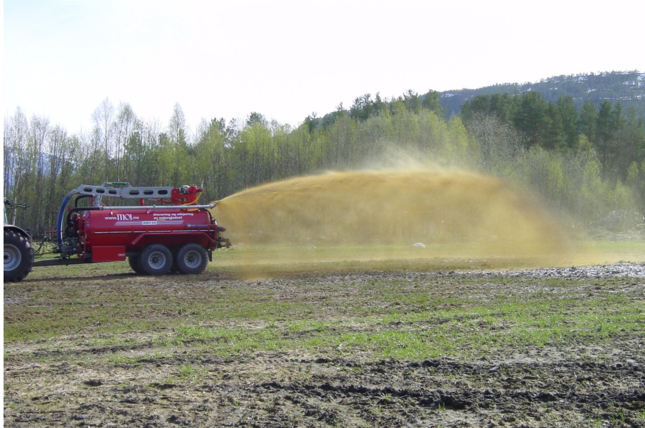
Kuva 30. Lietelannan levitystä hajalevityksenä imupainevaunulla (Moi As 2007a)
