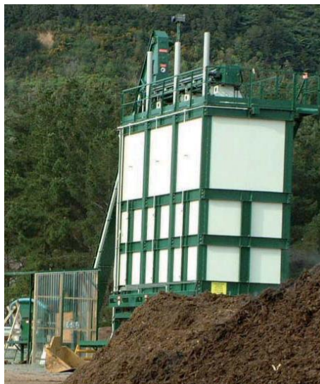
Kuva 19. Esimerkki tornikompostorista (Tirohia Compost Solutions Ltd 2007)
