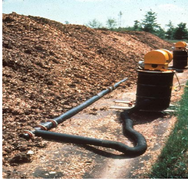
Kuva 17. Kompostiauman koneellinen ilmastus (Rynk et al. 2000)
