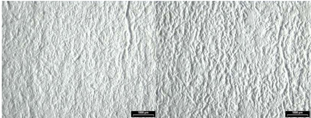
Kuva 1. Kuvassa on mikroskooppikuvia PK 7 paperin pinnasta. Vasemmalla puolella on pohjapaperin pinta. Oikealla on esipäälyllystetyn paperin pinta. Kuvat on otettu takareunasta ja paperin yläpuolelta. Valo ohjattiin kuvaushetkellä paperin pintaan kuvan oikeasta reunasta. Kuvat ovat 6 x suurennoksia.
