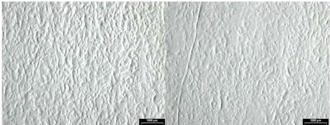
Kuva 2. Kuvassa on mikroskooppikuvia PK 7 paperin pinnasta. Vasemmalla puolella on kahteen kertaan päälyllystetyn paperin pinta. Oikealla on valmiin kalanteroidun paperin pinta. Kuvat on otettu takareunasta ja paperin yläpuolelta. Valo ohjattiin kuvaushetkellä paperin pintaan kuvan oikeasta reunasta. Kuvat ovat 6 x suurennoksia.
