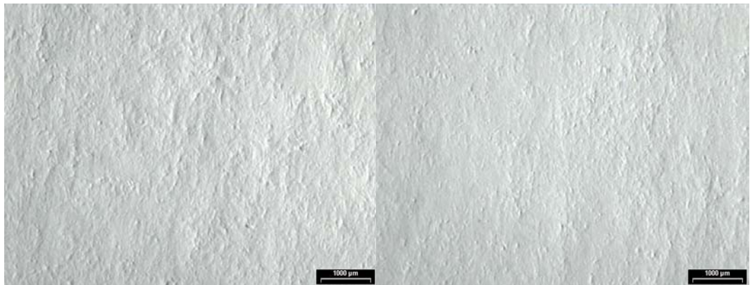
Kuva 5. Kuvassa on mikroskooppikuvia PK 7 paperin pinnasta. Vasemmalla on kahteen kertaan päälystetyn paperin pinta. Oikealla on valmiin kalanteroidun paperin pinta. Kuvat on otettu takareunasta ja paperin alapuolelta. Valo ohjattiin kuvaushetkellä paperin pintaan kuvan oikeasta reunasta. Kuvat ovat 6 x suurennoksia.
