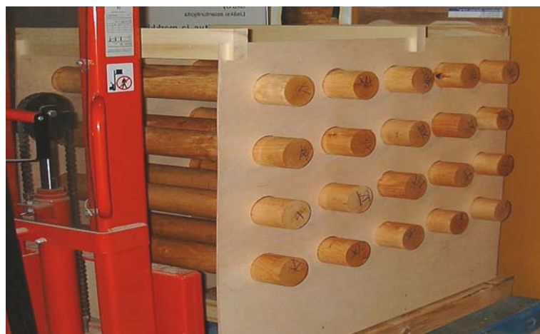
Kuvio 20. Koekuivauskuorma kosteushajonnan selvittämiseksi ennen kuivauskammioon siirtoa.
